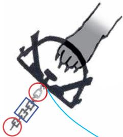
Insertion de la chaîne au centre du chassis
