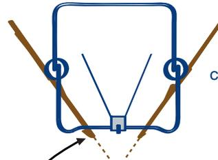
Tiges guides diminuant l'espacement tout en favorisant un contact rapide avec la détente
